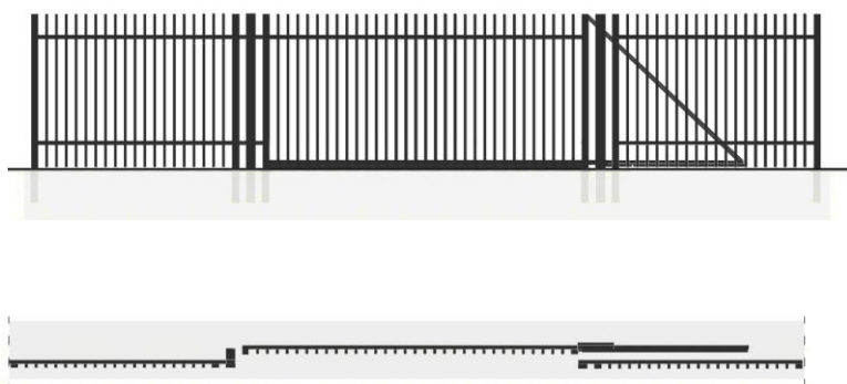
Rys. wersja 2 Brama przesuwana jednoskrzydłowa. Widok i rzut.
