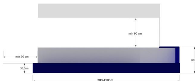
Rys. Rzut zabudowy
